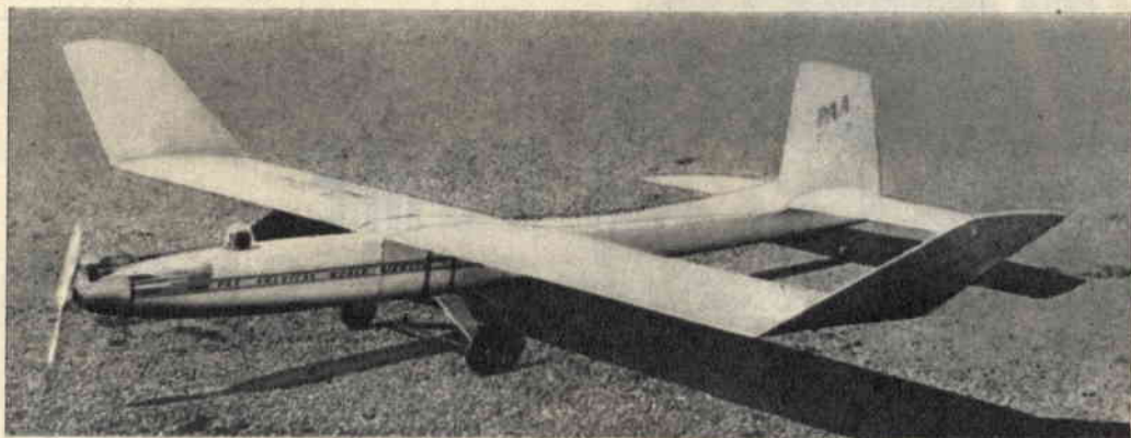
Fig. 3 - Le due estremità rialzate di cui è dotata l'ala servono a dare stabilità al modello. Esse si ottengono con lo stesso sistema con cui si è costruita l'ala. Devono essere incollate all'ala e rese solidali con questa mediante l'impiego di fettucce di seta incollate ad arte.
