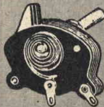
Fig. 1 - Schema elettrico del ricevitore (il particolare in basso, a destra, raffigura il condensatore variabile C1, così come esso è nella realtà).
