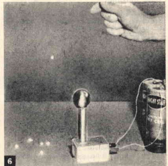
Fig. 6 - Moto oscillatorio di una pallina di carta legata ad un filo. Questo stesso effetto si può ottenere lanciando direttamente sull'opera altri corpi di materiale isolante: all'attrazione succede subito il fenomeno di repulsione.
