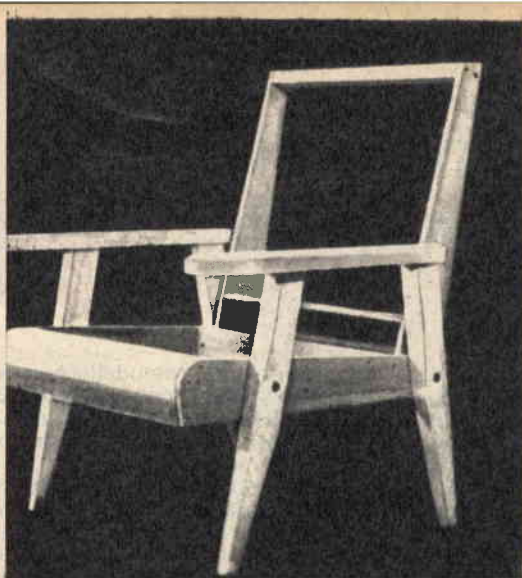
Fig. 1 - Questo elegante modello di poltrona, il cui scheletro risulta interamente costruito in legno, può essere facilmente realizzato da tutti gli appassionati di falegnameria con poca spesa e in breve tempo.
